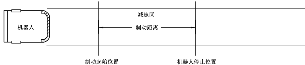
图 20 制动距离试验示意图
